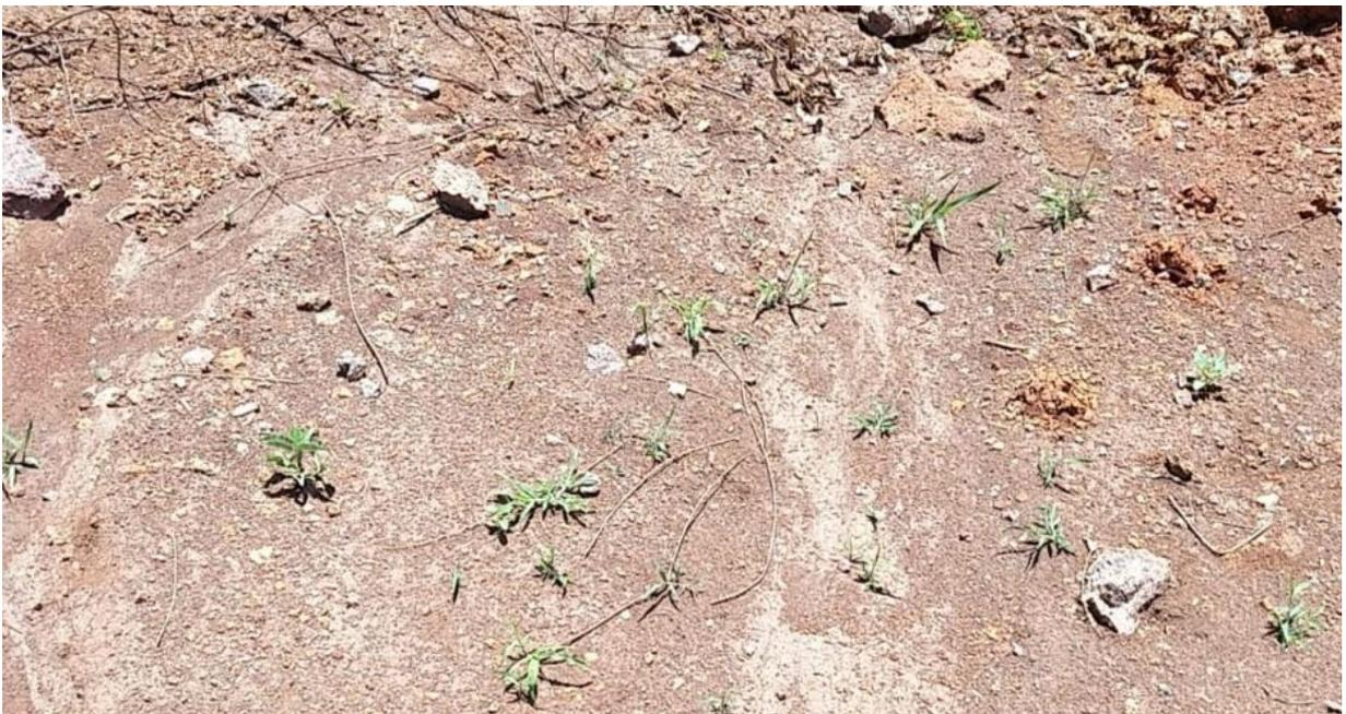
Figura 2- Silte arenoso
